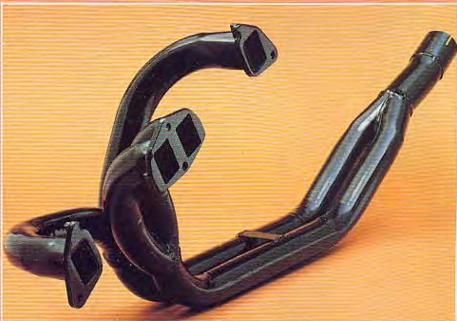
552298-2 Rally Avgassystem Komplett till 140-serien f.o.m. 1973 års modell.
